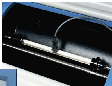
ADP410 con tubo de Polarímetro en
